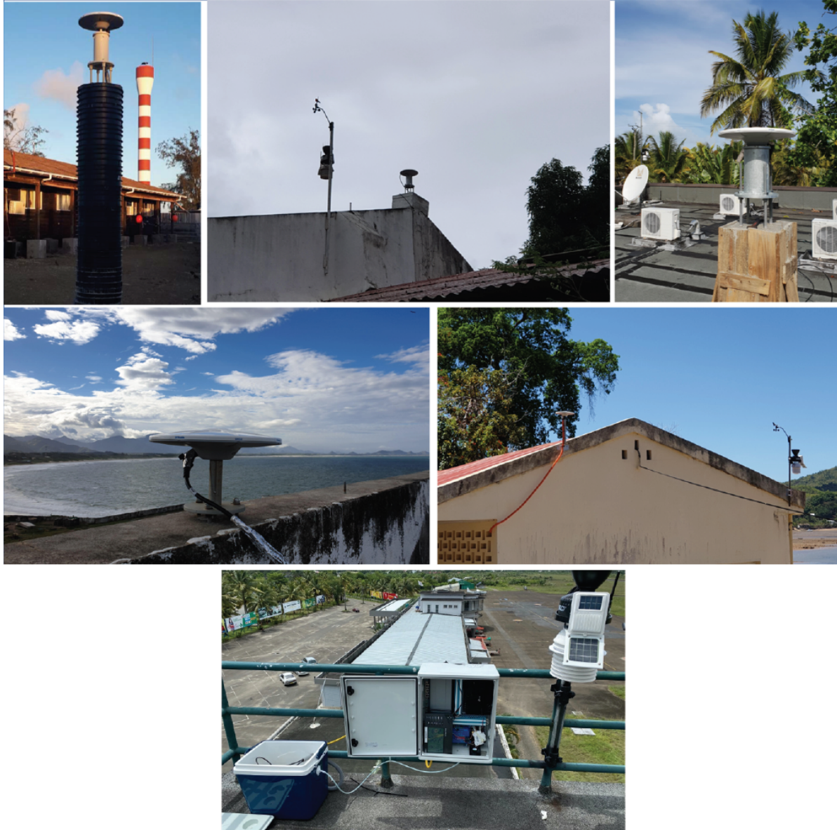
Figure 1 : Photographies des 5 stations GNSS installées dans le cadre du projet RNR-C3. De gauche à droite / bas en haut : Aldabra (SIF), Diego Suarez (IST-D), Sainte-Marie (Soanembo), Fort-Dauphin (Kaleta), Nosy Be (CNRO) et Tamatave (aéroport).
