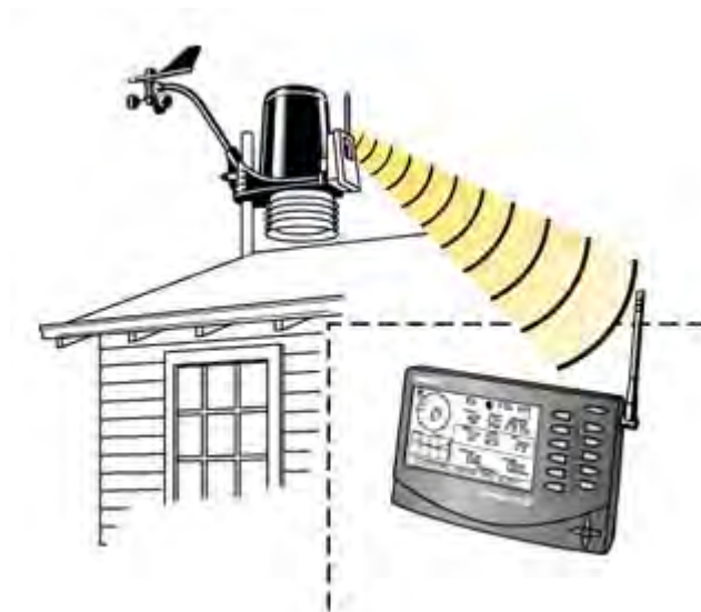
Figure 2.7 : Transmission par radio
