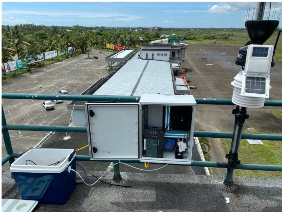
La station météorologique autonome développée par les étudiants de l'IST-D installée sur le toit de la tour de contrôle de l'aéroport de Tamatave en janvier 2020
