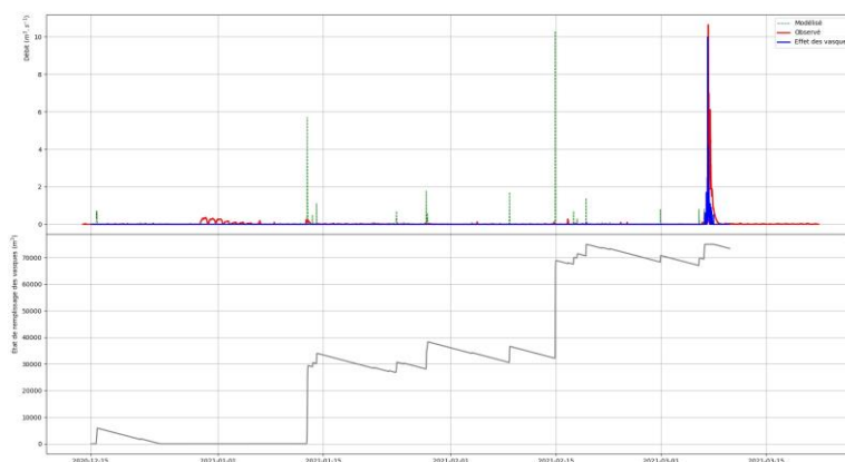
Figure 15: Modélisation des vasques correspondant à un stockage supplémentaire de 75\ 000 \text{ m}^3 avec un taux de vidange de 3,11 \text{ L} toutes les 6 \text{ minutes}
